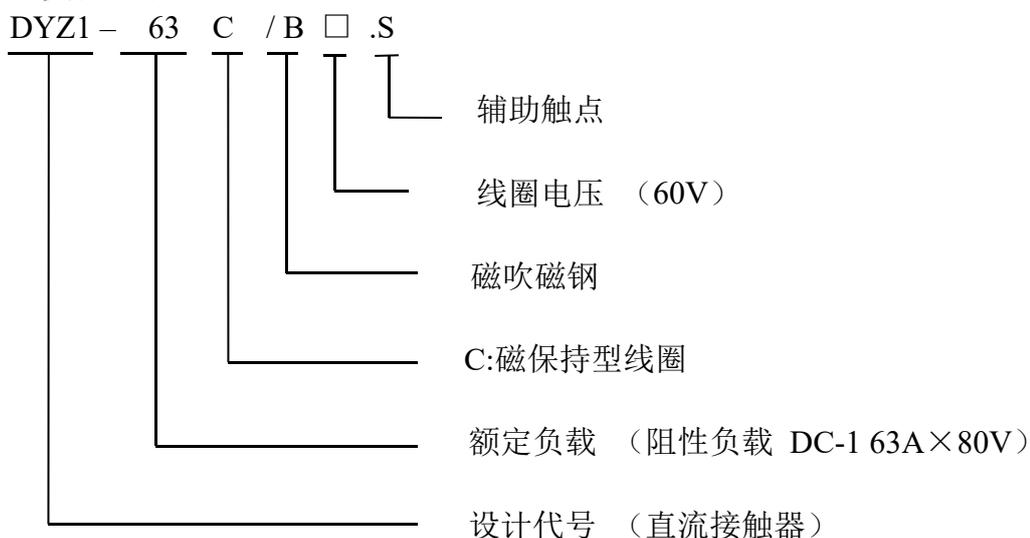
例: DYZ1-63C/B60.S; 表示: 磁保持直流接触器, DC-1 负载下额定电流为 63A, 线圈电压 DC60V 产品带磁吹磁钢, 带辅助触点。
